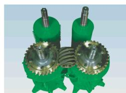
Sistema de transmissão com roscia sem fim (aço), e duas coroas de bronze lubrificadas em banho de óleo. Elimina a necessidade de lubrificação diária.
