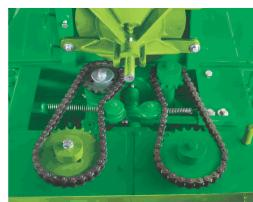
Caixa de engrenagens para mudança de tamanhos de corte, com parafuso de segurança de fácil remoção em caso de sobrecarga.
